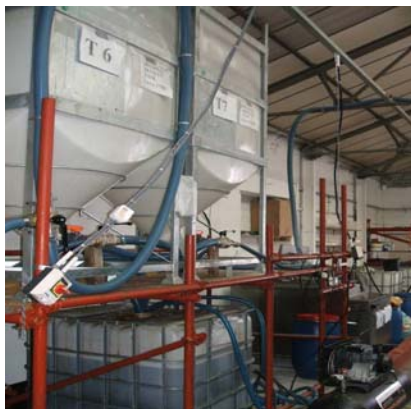
2. att. – konusveida cisternas, kurā izmantotā kulinārijas eļļa tiek sajaukta ar metanolu un nātrija hidroksīdu un katalizatoru.
