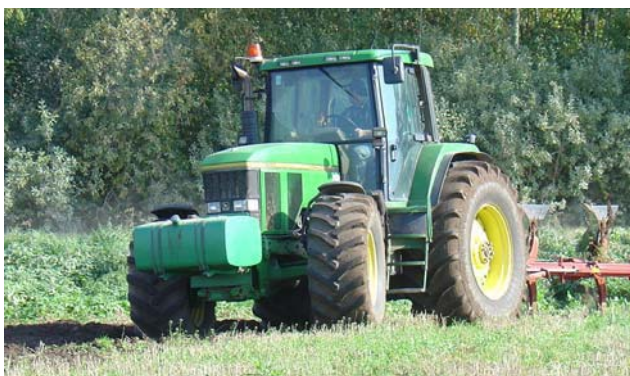
Traktors John Deere 7800, jauda 170 Zs, papildus degvielas tvertne rapšu eļļai uzstādīta traktora priekšgalā slogošanas atsvaru vietā (IECAVNIEKS)
